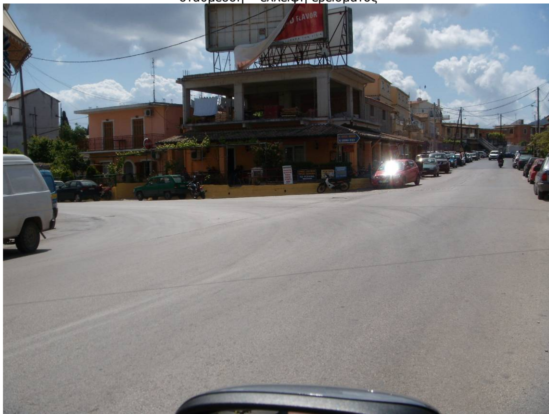
Εικ. 29. Διασταύρωση προς Μπενίτσες (Περιοχή Βρυώνη): Ανυπαρξία διαμόρφωσης κόμβου, έντονες παρόδιες χρήσεις, παράνομη στάθμευση
